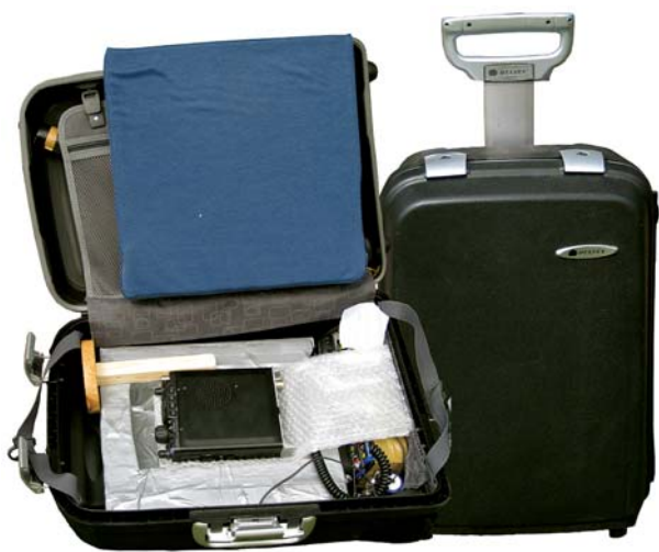
Alles drin im Afutrolley – der Autor packt alle für eine Amateurfunkstation nötigen Komponenten in einen gewöhnlichen Reisetrolley. Auf diese Weise hat man bei Portabeleinsätzen alles dabei, damit QSOs nichts mehr im Wege steht
