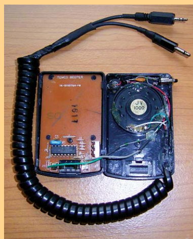
Die Innenansicht zeigt im rechten Gehäuseteil den nachträglich eingefügten PTT-Taster und die Mikrofonkapsel
