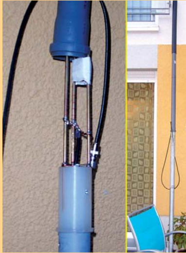
Detail- und Gesamtansicht der Duoband-J-Antenne
